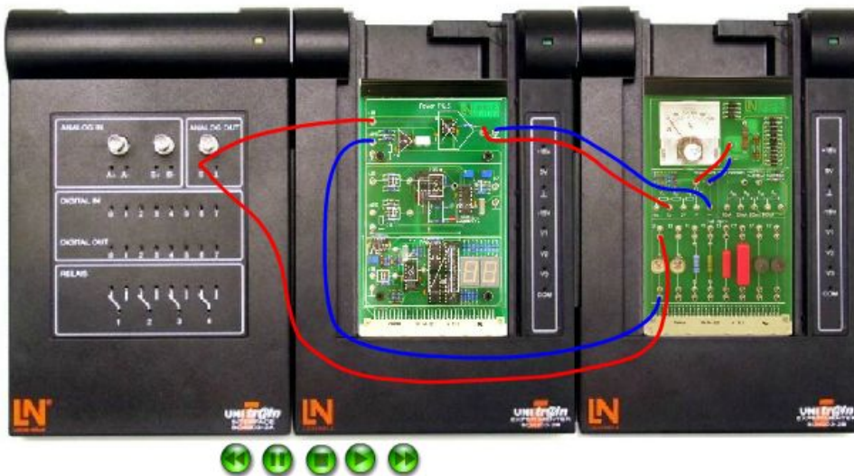
Fig.3. Măsurarea puterii electrice
